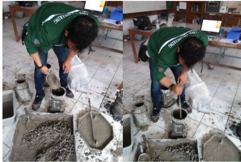
Gambar 15. Proses Penusukan Adukan Didalam Cetakan Silinder Serta Penggetaran Beton
