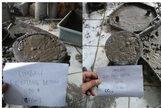
Gambar 16. Penyetakan Benda Uji Beton Silinder
