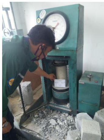
Gambar 20. Pengujian Kuat Tekan Beton
