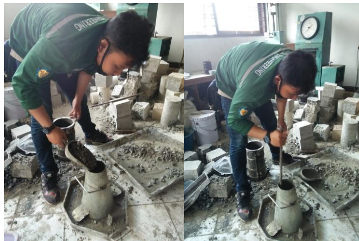
Gambar 13. Proses Pengisian dan Penusukan Adukan Beton ke Dalam Alat Slump Test
