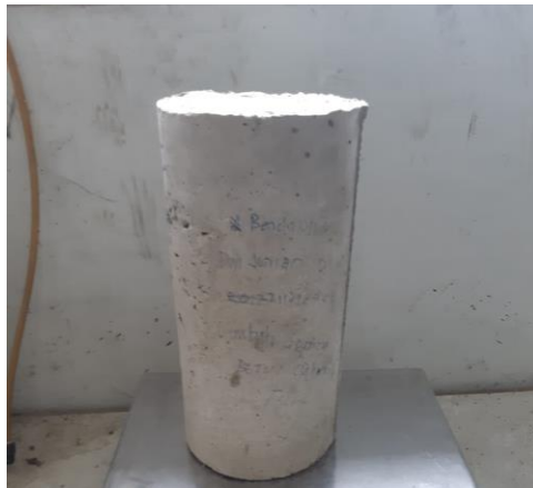
Gambar 17. Hasil Cetakan Benda Uji Beton Silinder
