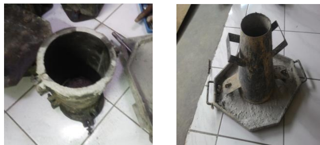
Gambar 6. Cetakan beton silinder & Alat slump test
