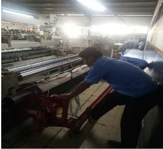
Menaikkan beam ke mesin weaving
