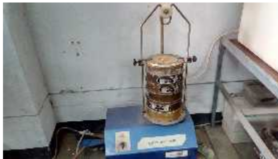
Gambar 4.4 Pengujian Analisa Saringan Agregat Kasar dan Halus
