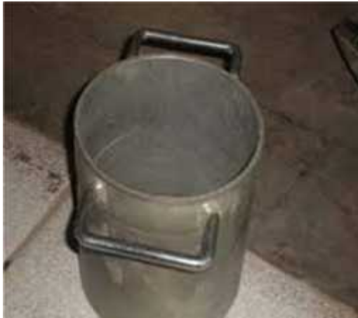
Gambar 3.6 Tabung untuk pengujian berat isi agregat
