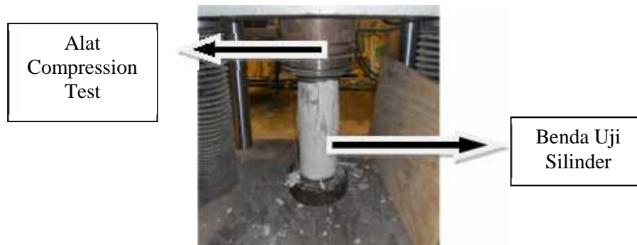
Gambar 3.9 Uji kuat tekan dengan Compression Test
