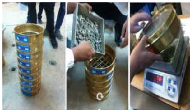
Gambar 3.4 Pengujian saringan agregat halus
