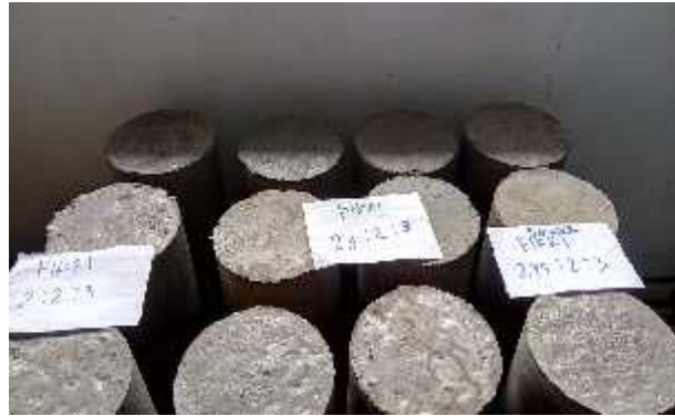
Gambar 4.8 Campuran Beton Setelah Dipadatkan Dan Diratakan
