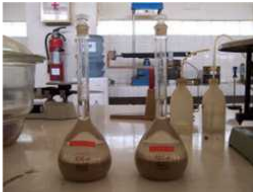
Gambar 3.5 Percobaan berat jenis agregat halus
