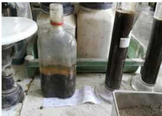
Gambar 3.7 Pengujian kandungan lumpur dan zat organik agregat halus
