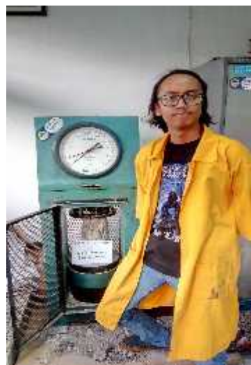
Gambar 4.10 Penunjukan Jarum Dial Pada Alat Uji Kuat Tekan
