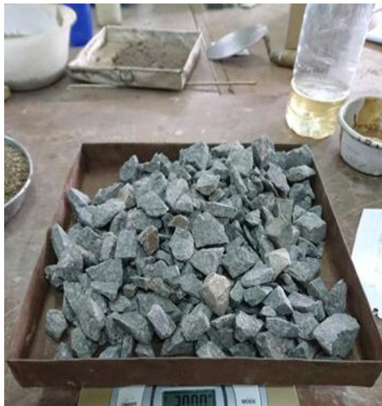
Gambar 12. Proses Pengujian Berat Isi Agregat Kasar
