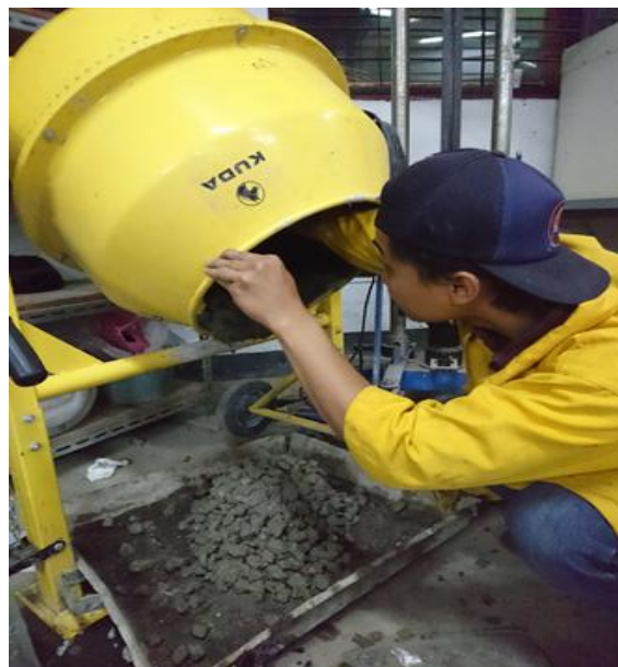
Gambar 18. Proses Pengadukan Beton
