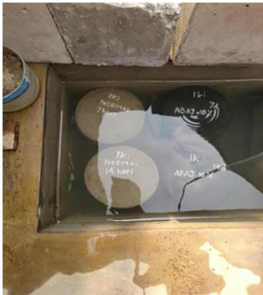
Gambar 22. Perawatan Beton/ Curring Selama 7 dan 14 Hari
