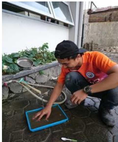
Gambar 7. Proses Pengujian Berat Jenis dan Penyerapan Air Agregat Halus
