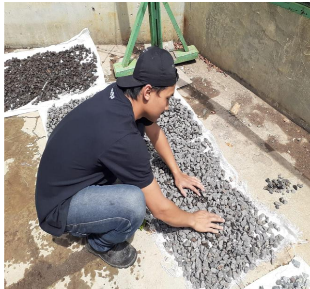
Gambar 16. Proses Pencucian dan Penjemuran Agregat
