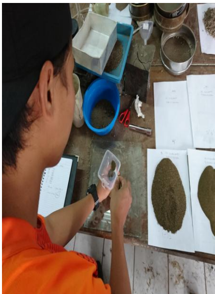
Gambar 6. Proses Pengujian Analisa Saringan Agregat Halus
