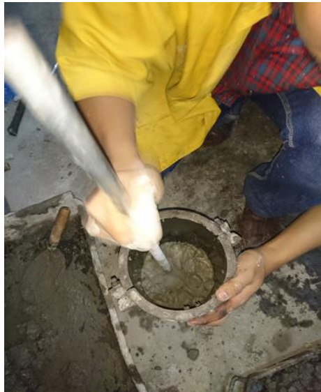
Gambar 20. Penuangan Adukan Beton ke dalam Cetakan Silinder Ø15 cm dan Tinggi 30 cm
