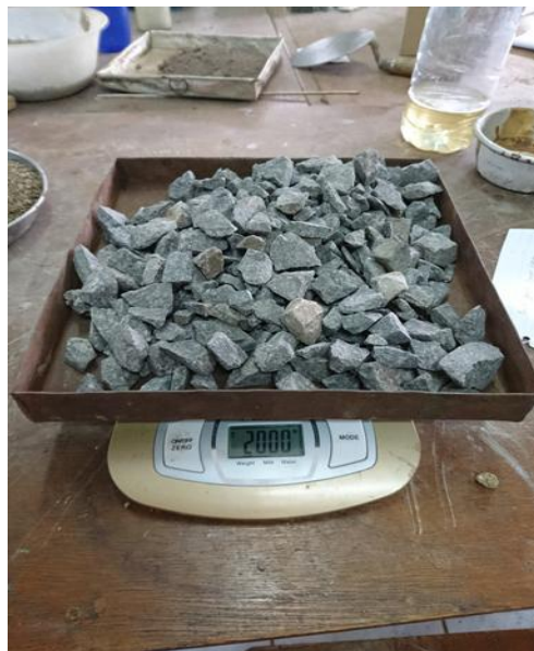
Gambar 10. Proses Pengujian Analisa Saringan Agregat Kasar
