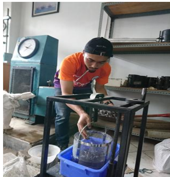
Gambar 11. Proses Pengujian Berat Jenis dan Penyerapan Air Agregat Kasar
