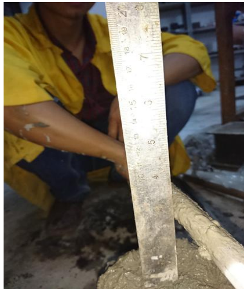
Gambar 19. Proses Tes Slump
