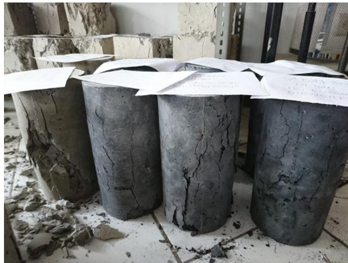
Gambar 24. Bentuk Fisik Beton Yang Telah Diuji Tekan 7 dan 14 Hari
