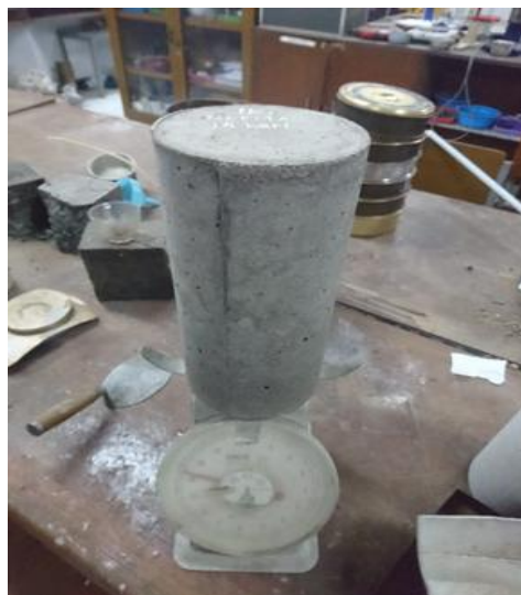
Gambar 21. Setting Beton 24 Jam, Pembukaan Beton Dari Cetakan, dan Penimbangan Berat Beton
