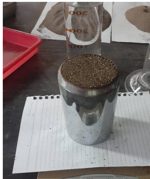
Gambar 8. Proses Pengujian Berat Isi Agregat Halus
